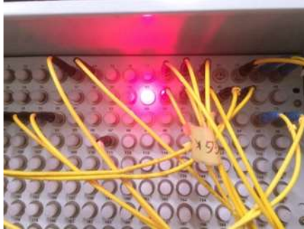
Gambar 8. Indikator VFL pada FTB
