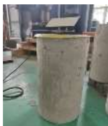
Gambar 4.3 Hasil uji kuat tekan benda uji tanpa perkuatan
